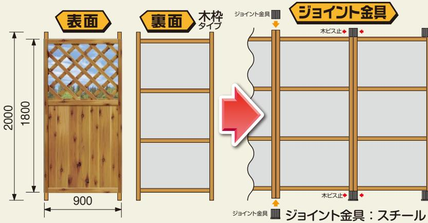
**単管で補強** 風の強い場所では単管で補強してください
